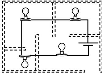
Un electricista le dice al arquitecto que debe cambiar el circuito porque al fallar uno de los bombillos se apagarán los demás. Él explica que en un circuito en serie, la corriente es la misma en todas las partes del circuito, mientras que en un circuito en paralelo, la diferencia de potencial es la misma en todas las partes del circuito. De acuerdo con lo que explica el electricista, ¿cuál es el mejor diseño que debería elaborarse para que la casa siempre esté iluminada si se daña un bombillo?
